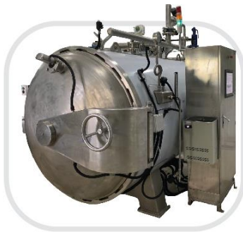
เครื่องฆ่าเชื้อภายใต้ความร้อนและแรงดัน หรือ เครื่องรีทอร์ท (Retort)
