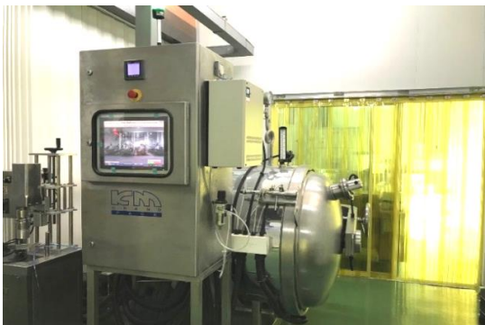
เครื่องรีเทอร์ทแบบพ่นน้ำร้อน (Water Spray Retort)
