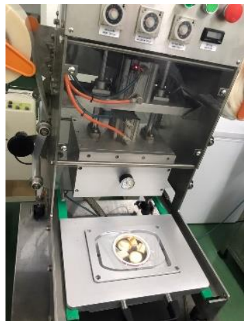
การปิดผนึกด้วยฟิล์มทนความร้อน และแรงดัน
